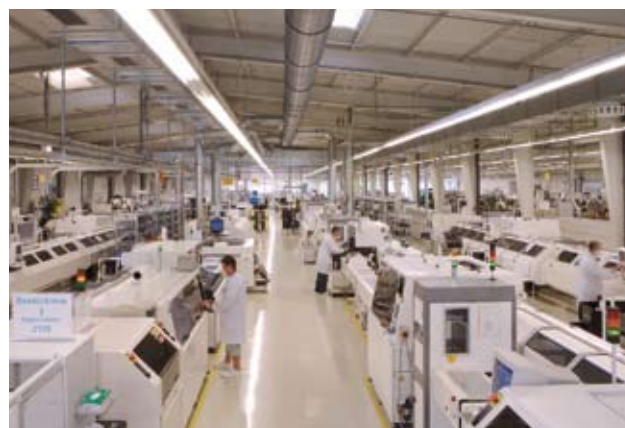
SMT-Linienfertigung bei DELTEC
