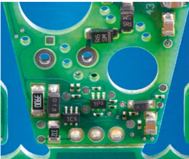
Zündelektronik bleifrei mit 0201-Bauteilen
